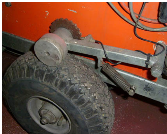
Abbildung 9: Montagebeispiel für Wegaufnehmer auf Kleinmarkiermaschine
