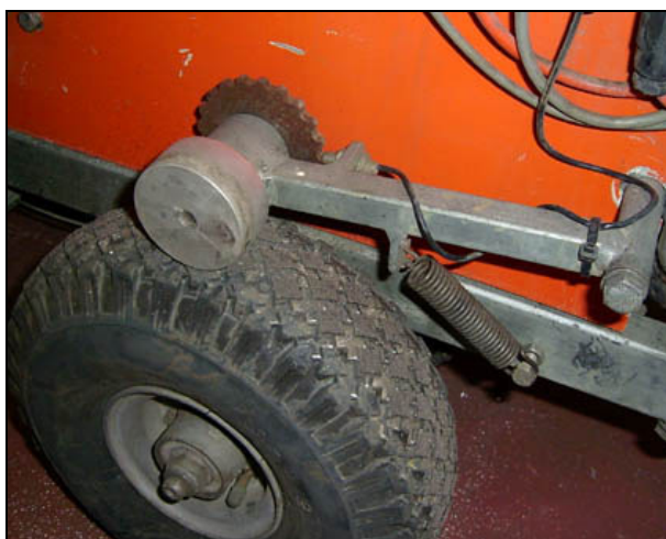
Abbildung 7: Montagebeispiel für Wegaufnehmer auf Kleinmarkiermaschine
